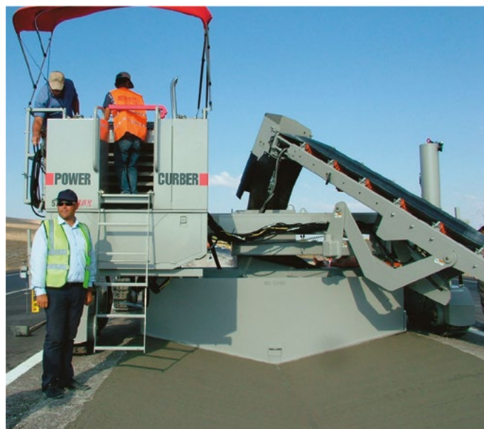
Создание V-образной формы в Турции, ширина 3,8 м, глубина 0,6 м, смежная с покрытием с двух сторон (с транспортером, созданным на заказ).
