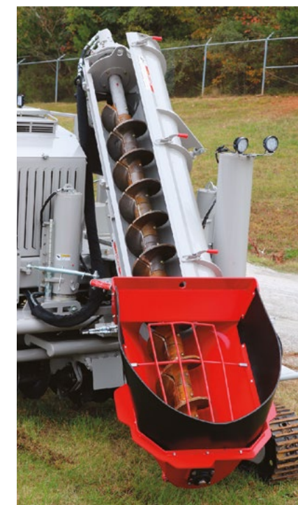
Шнековый транспортер; крышка открывается для очистки.
