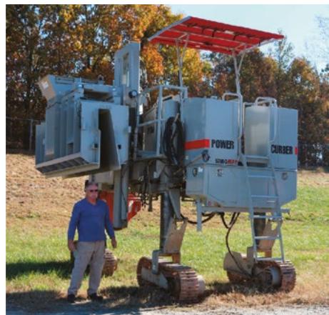
5700-D-MAX, оборудованная подъемом формы барьера.
