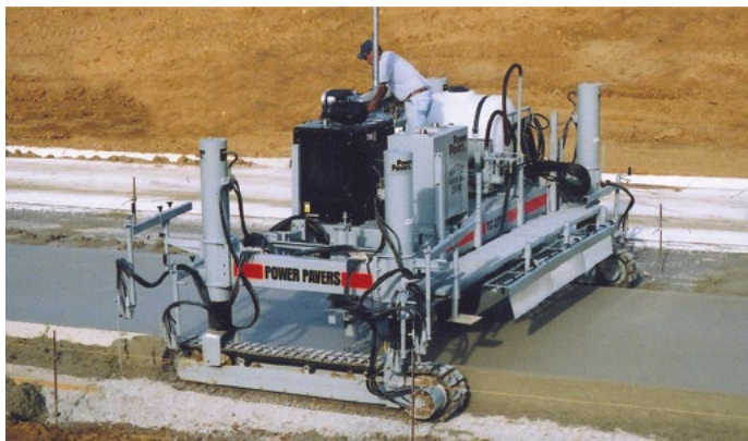
Машина для текстурирования и обработки бетонных поверхностей Power Pavers TC-2700.
